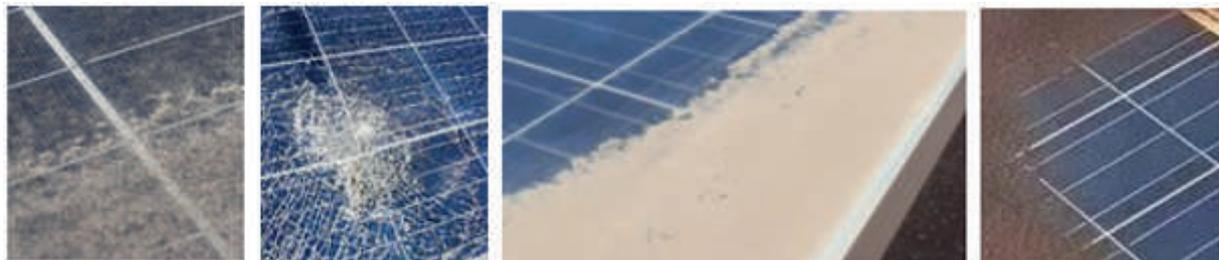
Figure 36. Exemples d'encrassement de modules PV.
