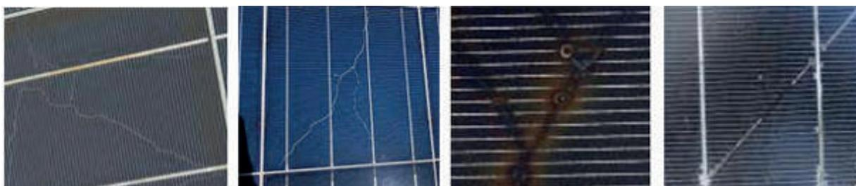
Figure 30. Exemples de fissure sur des cellules PV.
