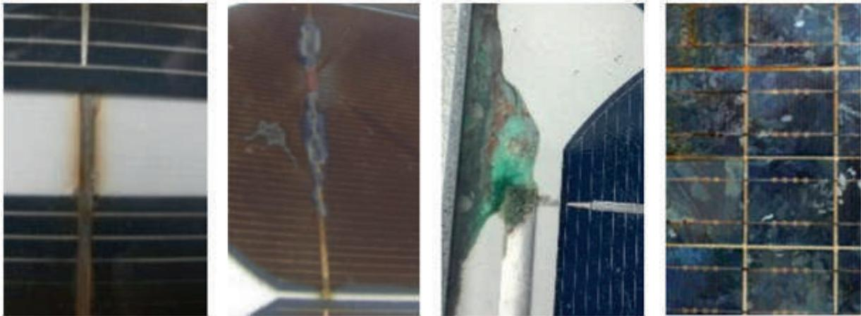
Figure 27. Exemples de corrosion des interconnexions.
