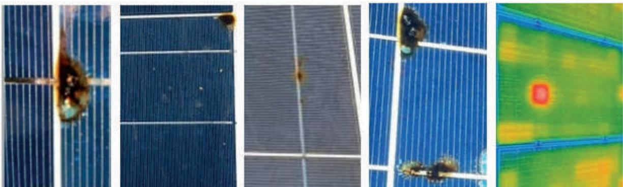
Figure 32. Exemples de points chauds (Hot spot).
